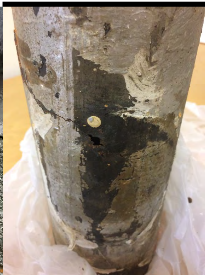
Foto vänster: Vid renovering av lgh stötte armeringsnät mot bef. avloppsrör och orsakade hål. Foto höger: Utbytt del av stamledning med rosthål. Foton ej specifika för Torsken 5.
