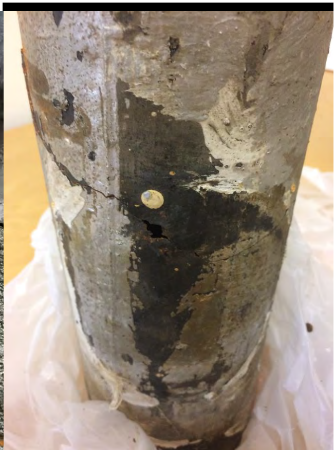
Foto vänster: Vid renovering av lgh stötte armeringsnät mot bef. avloppsrör och orsakade hål. Foto höger: Utbytt del av stamledning med rosthål. Foton ej specifika för Torsken 2.
