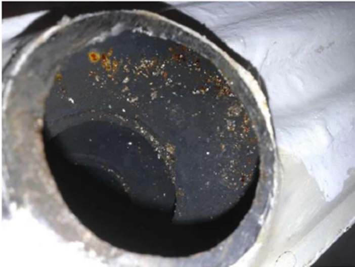
Bild på insida av originalradiator itu sågad.
