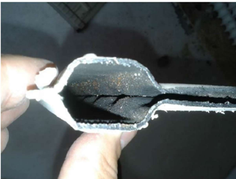
Bild på insida av befintlig nyare radiator itu sågad. Bild visar korrison och rost inuti radiator vilket tyder på ett otätt värmesystem.
